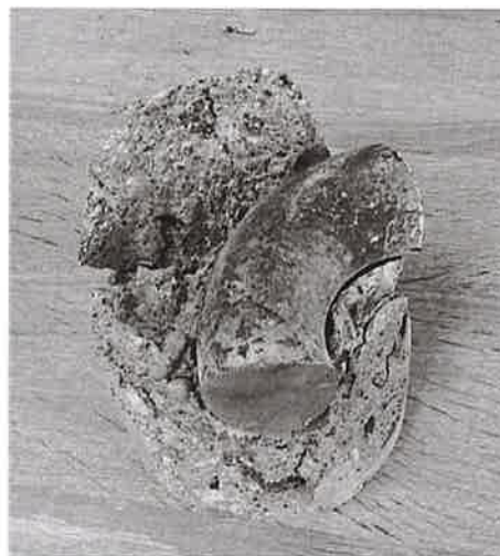
Fot 1. Zbrojenie w próbce nr 2
